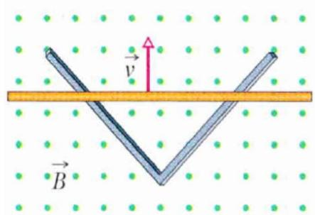
5) Şekilde dik açılı iki düz iletken ray üzerindeki bir iletken çubuk  $t=0$  da köşe noktadan harekete başlayıp 5,20 m/s lik sabit hızla hareket ediyor. Manyetik alanın yönü sayfa düzleminden dışarı doğru olup büyüklüğü  $B=0,35$  T'dır.
